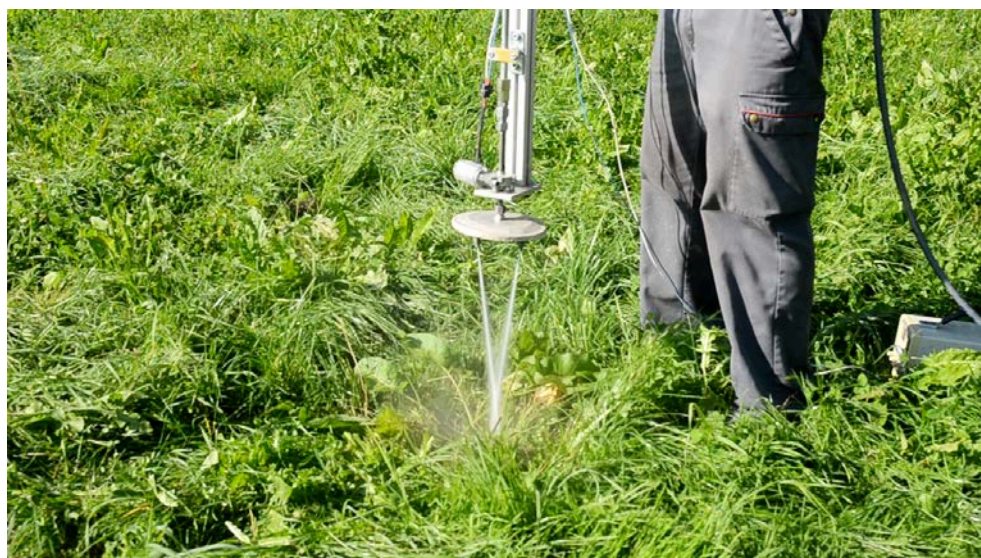
Test della testa di applicazione in condizioni reali. All'inizio del processo la sovrapposizione dei getti d'acqua è facilmente riconoscibile, Roy Latsch, Agroscope.
